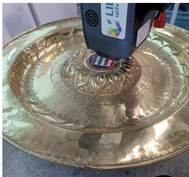
Analyse par XRF portable d'un bassin du corpus Promatech. Photo Grégoire Chêne.
